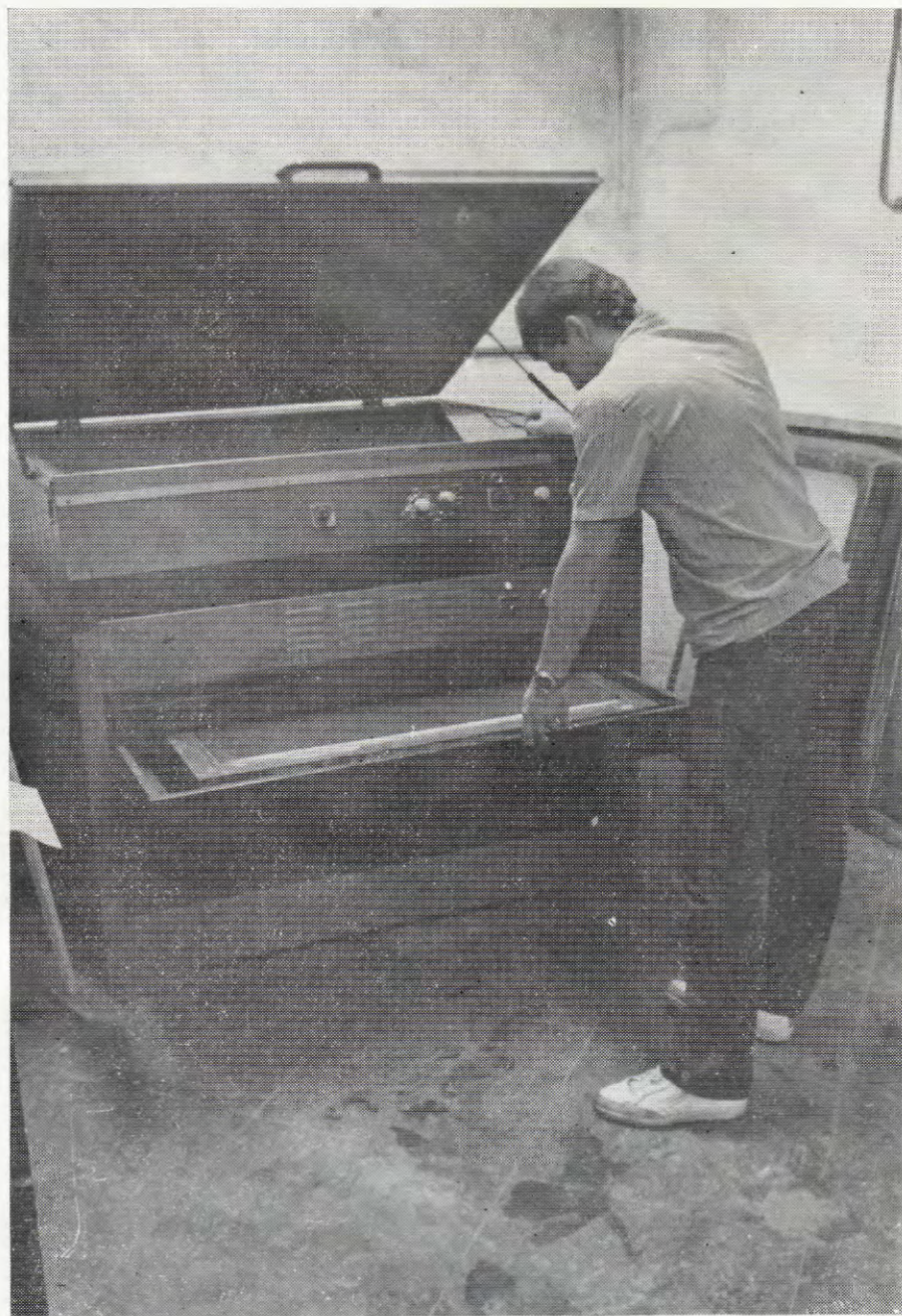
Secado de la pantalla en el equipo insolador.
